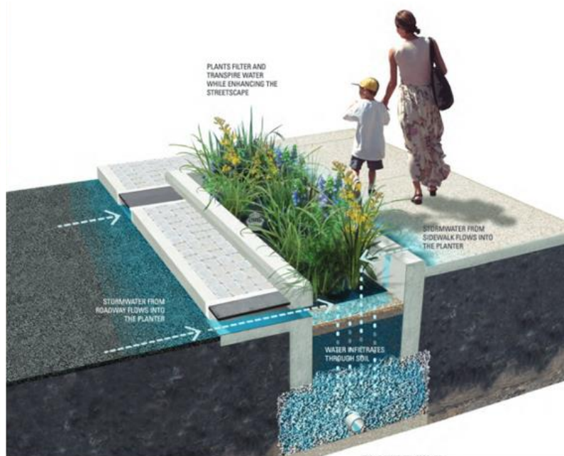
Exemple de rétention des pluies d'orages en intégrant des aménagements au sein des espaces publics - réduction des pollutions, du ruissellement en ville et contrôle du débit (source : Portland dans l'Oregon)
